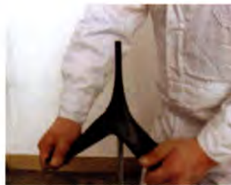
产品耐穿刺性能试验
